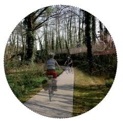
Une rampe douce de 137 m de long et 2 m de large avec une pente de 4% ponctuée de paliers de repos successifs permet de relier le point haut du talus au cheminement des bords du gave.
