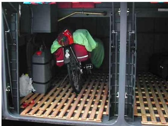
**Illustration 17 :** Photo de vélo en soute, sans fixation. Source : [www.cyclosite.be](http://www.cyclosite.be)
