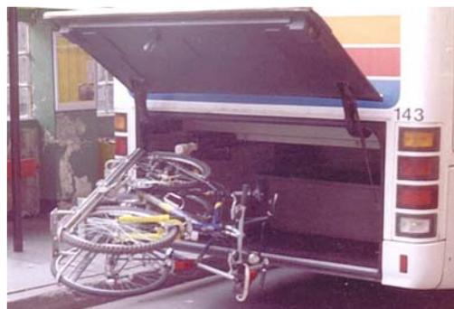
**Illustration 19 :** Photo embarquement de deux vélos dans le coffre arrière de l'autocar à l'aide d'un système de fixation pivotant. Système pilote mis au point dans le cadre du programme « Scottish Cycle Challenge ». Source : Transport Management Solutions, Cycles on Buses and Coaches
