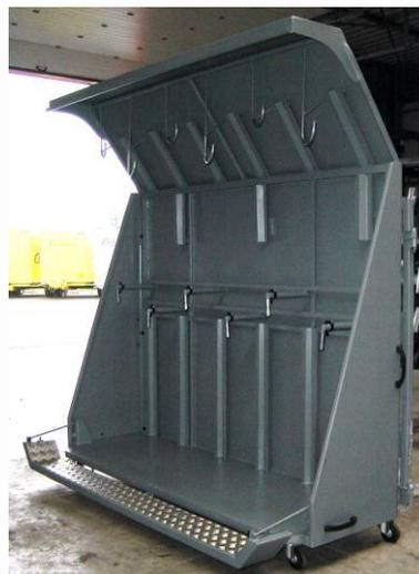
**Illustration 16 : Photo de porte-vélos avant son installation sur un autocar. Source :CarSpeed Industries**
