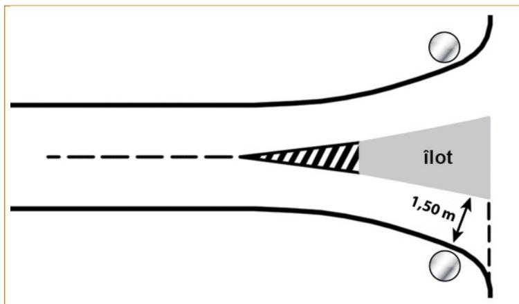
Ces îlots pourront être construits en s'inspirant des recommandations données pour les carrefours interurbains en adaptant les dimensions à celle de la voie verte et aux trajectoires cyclistes.
