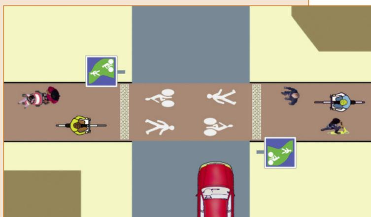
La signalisation verticale utilisée pour la voie verte sera le panneau Ab3a en position. Pour la ligne d'effet il sera mis en place une ligne T'2 réduit de 50 % (carrés de 25 x 25).
