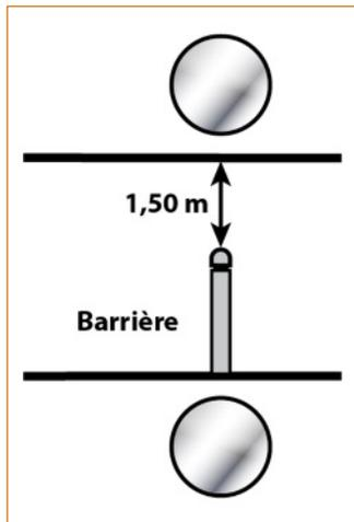
Les système latéraux ne devront pas être agressifs, le passage de 1,50 m (d'un côté ou des deux côtés) permet de réserver un bon confort aux cyclistes et interdit l'accès aux véhicules motorisés à 4 roues.
